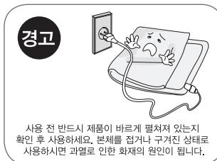
사용 전 반드시 제품이 바르게 끌쳐져 있는지 확인 후 사용하세요. 본체를 접거나 구겨진 상태로 사용하시면 고열로 인한 화재의 원인이 됩니다.
